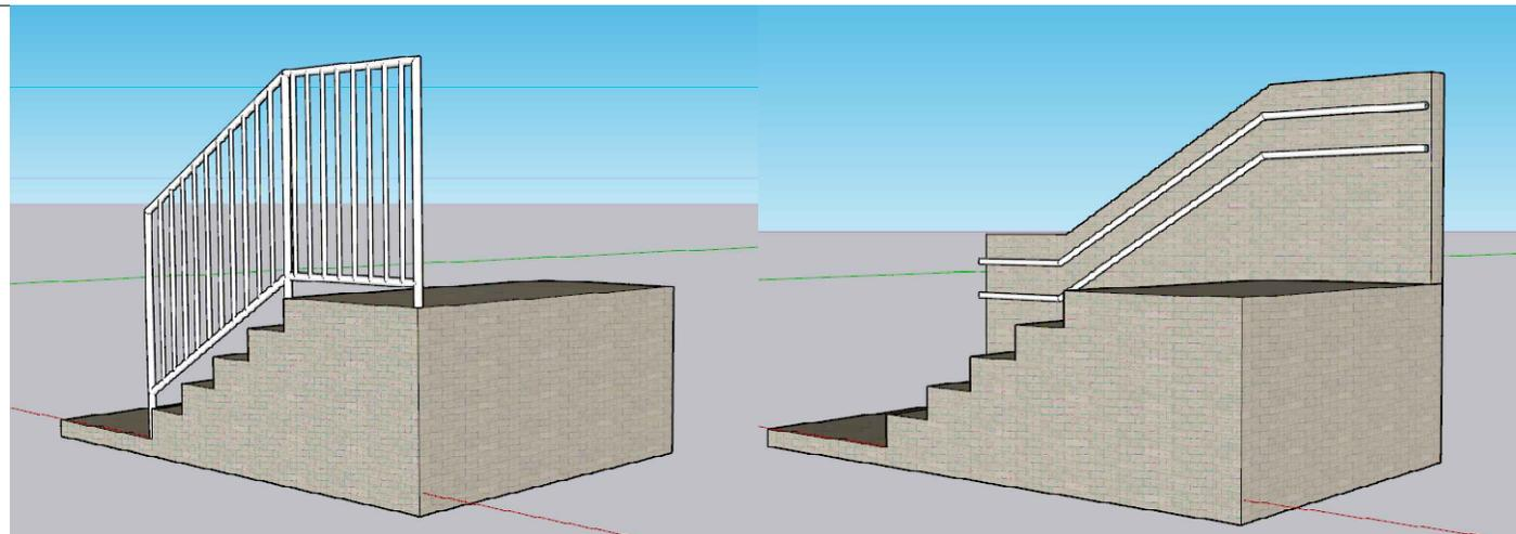
Guarda-corpos e corrimãos em alumínio pintado fixado em estrutura existente
