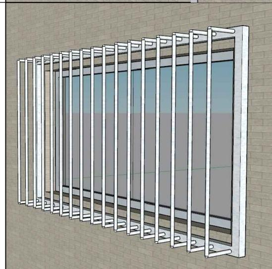
Grades para janelas em aço carbono, fixado com parafuso e bucha em parede de alvenaria
