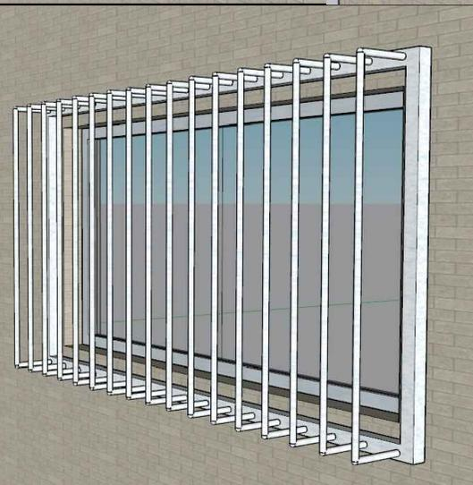
Grades para janelas em alumínio, fixado com parafuso e bucha em parede de alvenaria
